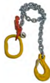
CH-07-....-CRH Chain, Clutch + Hook + Ring Length 150/200 mm, WLL 1,5 ton
